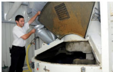
> Le Groupe modernise sa **centrale à béton de Bressuire (79)**. Cette installation nouvelle génération bénéficie de la dernière technologie avec, notamment, un malaxeur EPM 3000 / 2000 ES, de 2 m<sup>3</sup>. Ses atouts : une grande capacité de malaxage et de fabrication de bétons plus élaborés tels que les gammes ONDALISS®, LUMILISS® et DURALISS® développées par le Groupe.
