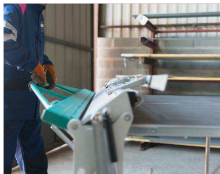
Plieuse à zinc Crédit photo : Charles Marion
