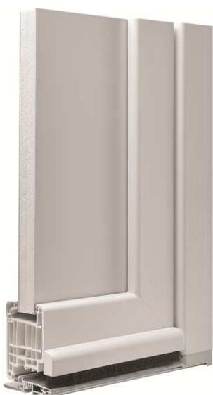
Pour son offre de **portes PVC à panneaux (36 mm)**, VENDÔME innove avec un **ouvrant fibré** sans renfort en acier. **Résultat d'une technologie exclusive**, l'ouvrant de 82 mm d'épaisseur est **intégralement et systématiquement renforcé par des bandes de fibres de verres continus**. Au total, 200 000 mètres de fibres de verre sont utilisés par mètre de profil.
