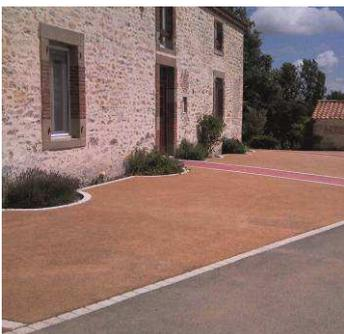
Ce béton monogranulaire de porosité importante peut être coloré dans la masse et s'applique en extérieur. Le fond de forme requiert une préparation spécifique; soit une pente adéquate, soit un système de drainage permettant l'évacuation des eaux de ruissellement.
